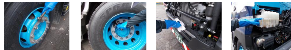
安全運転のために収集運搬車の出庫前点検 一部の様子 (左から、ホイールのボルト・ナットの締め具合の確認(2枚目も同じく)、エンジンオイルの確認、ラジエーター水の確認)
