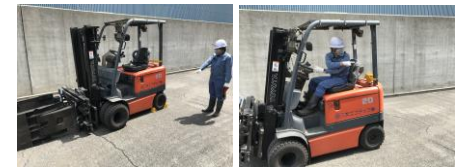
安全教育（実技）フォークリフト運転 （左写真：輪留めの確認、右写真：左後方の確認）
