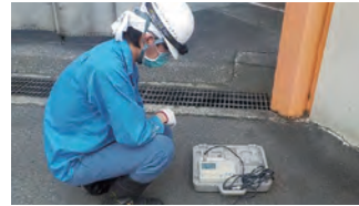
振動測定（第一工場）
