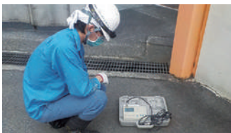
振動測定（第一工場）
